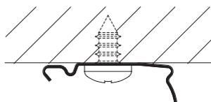
**2** Emboîter le decant du rail dans les clips. Puis pousser l'arrière du rail dans les clips jusqu'au "clac".
