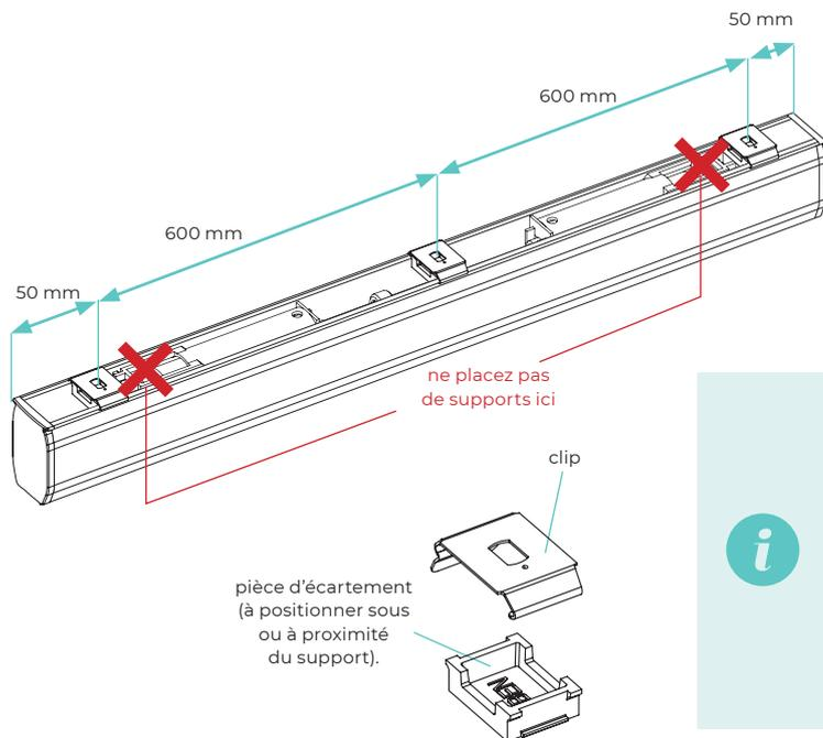
Fixer les clips à 50 mm respectivement de l'extrémité du boîtier, en respectant une distance max. de 600 mm entre les clips.
